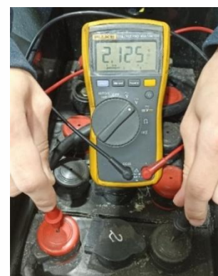
Figura 26 – Medição de tensão de um elemento.
