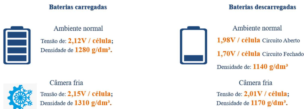
Figura 14 – Densidade e tensão das baterias.
